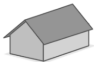
Toiture à deux pans
