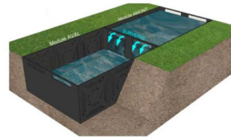
Figure 1: Principe d'installation avec surverse - source : EFOH
