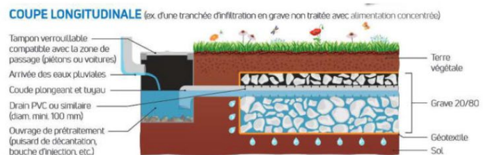
Figure 5: Extrait de la fiche n°2 - ADOPIA - La tranchée d'infiltration
