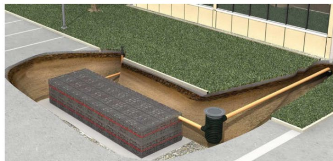
Figure 7: Exemple d'une structure ECOBLOC - Source GRAF
