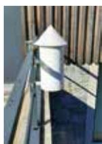
En 2023, la commune s'est équipée d'un appareil de mesure de l'air qui a été installé à l'extérieur de l'espace 1. 2. 3. Il surveille ce que nous respirons (NO<sub>2</sub>, CO, CO<sub>2</sub>, O<sub>3</sub>, COV) et les microparticules (PM<sub>2.5</sub>), ces données sont à interpréter en fonction des conditions météorologiques sur une plage significative.
